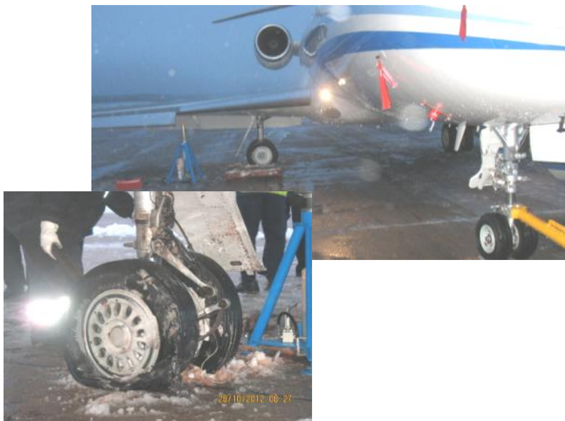
Фото 1 и 2. Повреждения самолета в результате столкновения с дикими животными
