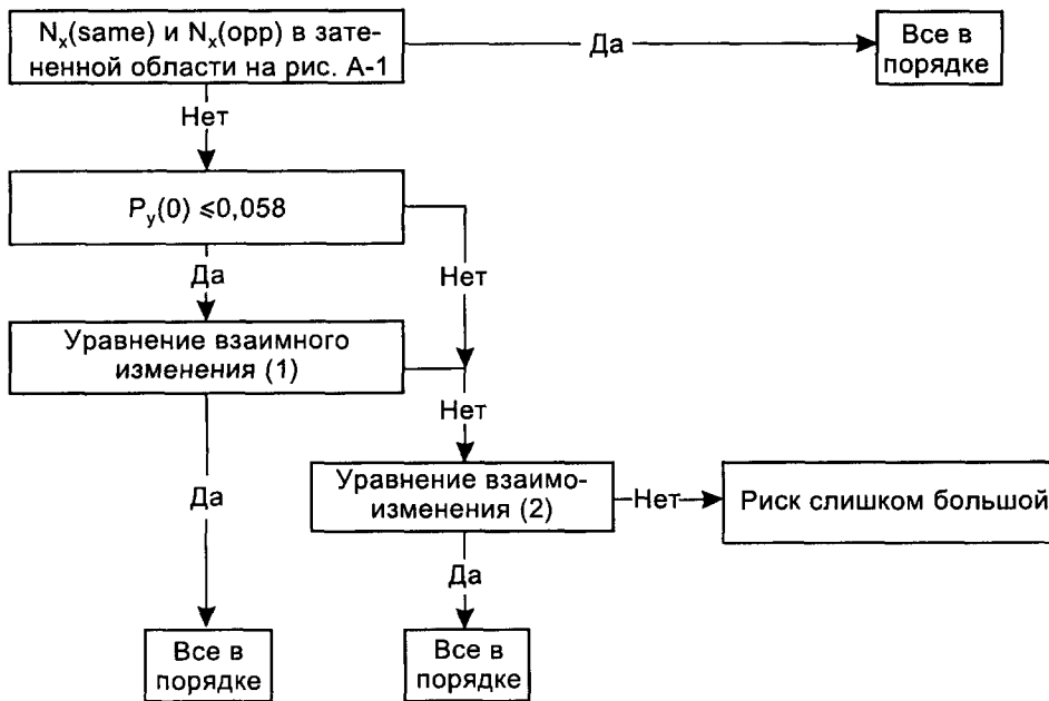
Рис. А-2. Блок-схема взаимного изменения параметров глобальных технических требований к характеристикам системы применительно к воздушному движению в одном и встречных направлениях при P_y(0) \leq 0,058 и условии, что P_z(1000) \leq 1,7 \times 10^{-8}
