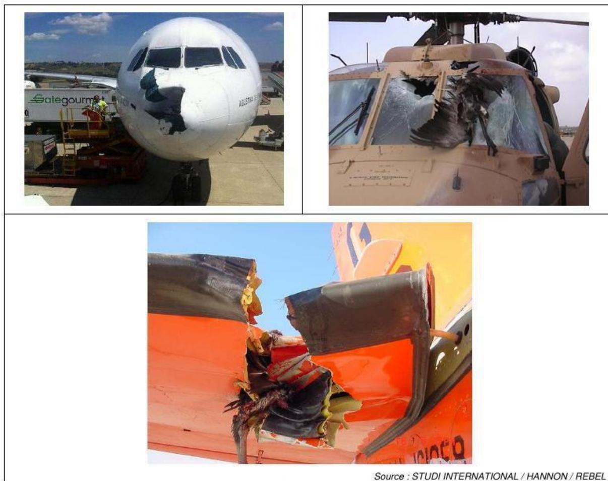
**Fig. 22 : Exemples de dégâts occasionnés par le péril aviaire**
