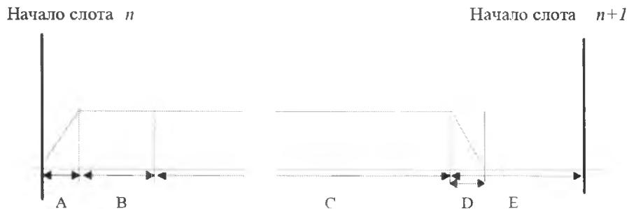
2.12.2.2. Сегмент стабилизации мощности передатчика должен иметь продолжительность в 832 мкс. Уровень мощности передатчика в конце сегмента стабилизации мощности должен быть не менее 90 % от среднего уровня выходной мощности, измеренного в процессе передачи сигнала (установившийся уровень мощности).
