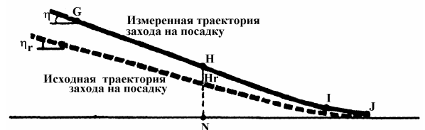
Рис. А5. Сравнение измеренной и исходной траекторий захода на посадку
